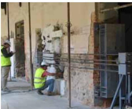
A través de un convenio de colaboración entre ACCIONA I+D y GTED-UC se están llevando a cabo **ensayos de carga hasta rotura** (bajo acción horizontal), de varios **paneles de Mampostería** de diferentes muros portantes en un edificio de finales del XIX: Se trata de
