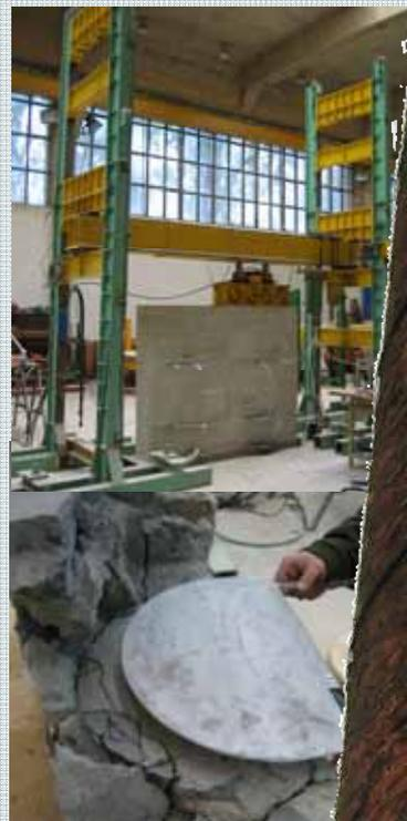
**Campañas experimentales de hole drilling empleando extensometría de fibra óptica y extensometría resistiva.**
